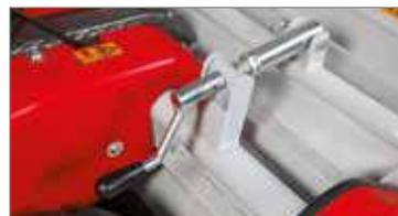
Altura de corte regulable fácilmente con una palanca de husillo.
