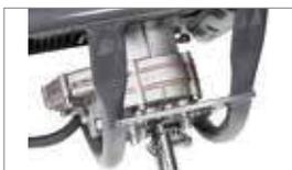
Caja de engranajes profesional de aluminio con engranajes montados sobre rodamientos, garantía de larga duración, funcionamiento silencioso y baja vibración.
