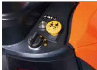
Para accionar las cuchillas, el operador debe simplemente pulsar la tecla de mando del embrague electromagnético situada en el salpicadero. Este sistema garantiza la activación de las cuchillas sin contragolpes.
