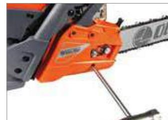
Tensor de cadena lateral: facilita el ajuste de la cadena evitando el contacto directo con ella. Las tuercas de bloqueo están fijadas al cárter de la cadena para evitar que se pierdan.
