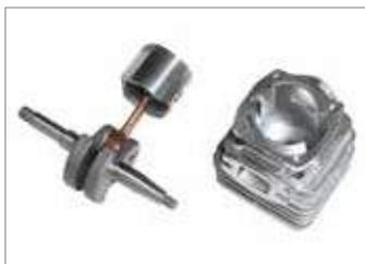
Pistón con dos segmentos elásticos, eje y biela de acero forjado y mecanizado, jaulas de rodillos, cilindro revestido en níquel: rendimiento constante a lo largo del tiempo incluso en uso exigente.
