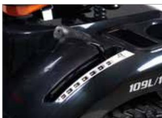
Práctica palanca de regulación de la altura de corte en 7 posiciones, situada al alcance de la mano y provista de escala graduada para visualizar inmediatamente el nivel seleccionado.
