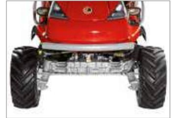
Las bandas de rodadura anchas y el centro de gravedad bajo aseguran la máxima estabilidad en terrenos accidentados o en proximidad de orillas y cunetas.
