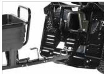
El enganche de remolque, de serie, hace la máquina aún más versátil por la posibilidad de tirar de un carro o un rodillo.
