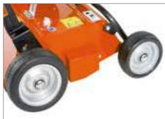
Ruedas metálicas con rodamientos de bolas.
