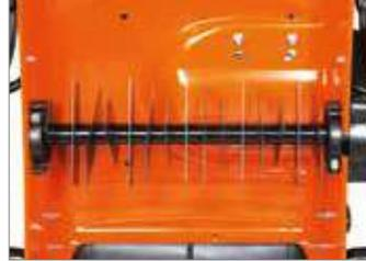
Rotor compuesto por 15 cuchillas fijas.
