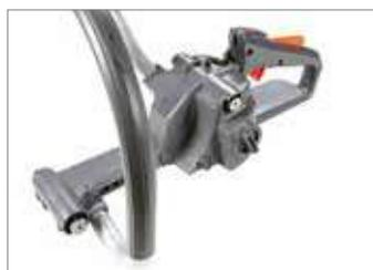
Sistema antivibración formado por seis amortiguadores, dos de muelles y cuatro de goma, situados entre las empuñaduras de los mandos y el bloque del motor: aísla al operario de las vibraciones reduciendo la fatiga.
