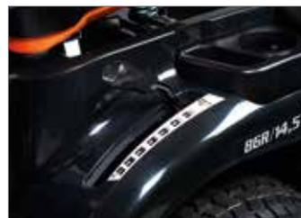
Regulación de la altura de corte mediante una práctica palanca al alcance de la mano con escala graduada que permite la inmediata visualización del nivel de altura de corte deseado.
