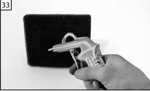
**فلتر الهواء** - في حالة انخفاض قوة المحرك كثيرًا، قم بفتح الغطاء (A، صورة 29) وراجع حالة مرشح الهواء (B). نظف بمزيل شحوم Emak cod. 001101009. اغسل بالماء وانفخ من مسافة بالهواء المضغوط (صورة 33). قبل تركيب الفلتر الجديد، قم بإزالة كبير الاتساخ من ناحية الجانب الداخلي للغطاء والمنطقة المحيطة بالفلتر.
